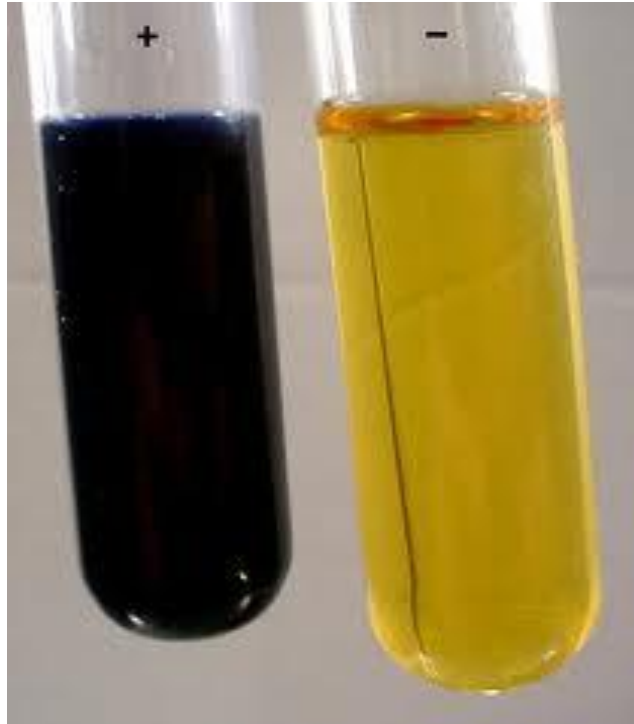
เมื่อทดสอบแป้งด้วยสารละลายไอโอดีนจะได้สารสีน้ำเงินม่วง
